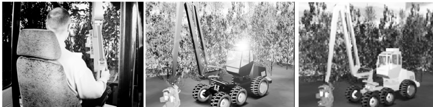
Bild 9: Virtueller Test der Harvester Kransteuerung (linkes Bild) sowie verschiedene Designvorschläge
